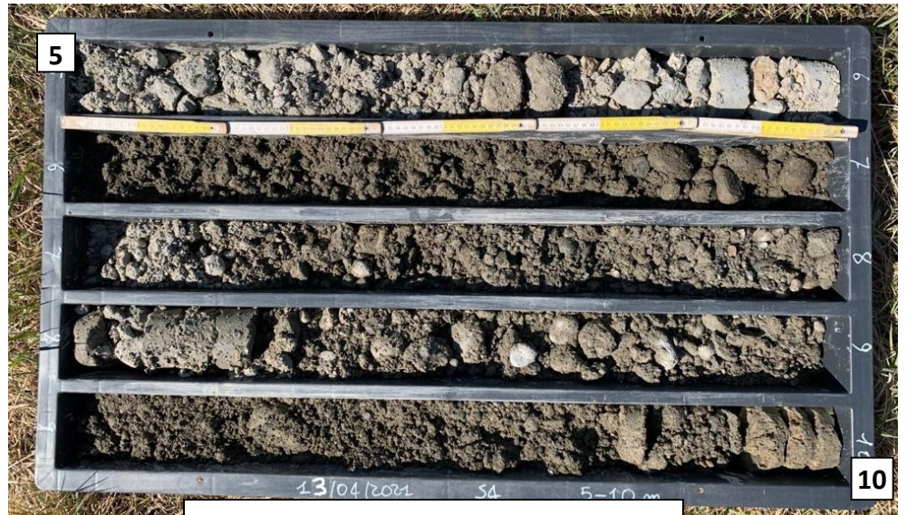
RIGAMONTI SALUMIFICIO S.p.A. Montagna in V.na (SO) SONDAGGIO S4 Cassetta da m 5.00 a m 10.00
