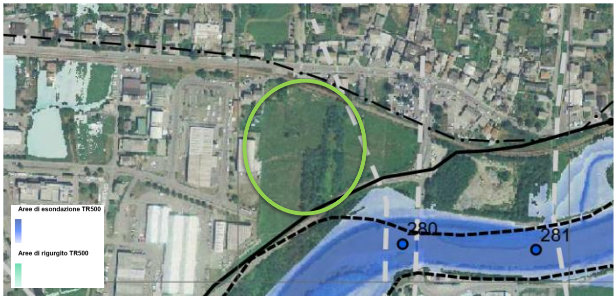
Tavola di delimitazione delle zone di esondazione con tiranti idraulici Tr500 - Sondrio
