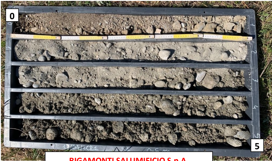
RIGAMONTI SALUMIFICIO S.p.A. Montagna in V.na (SO) SONDAGGIO S4 Cassetta da m 0.00 a m 5.00
