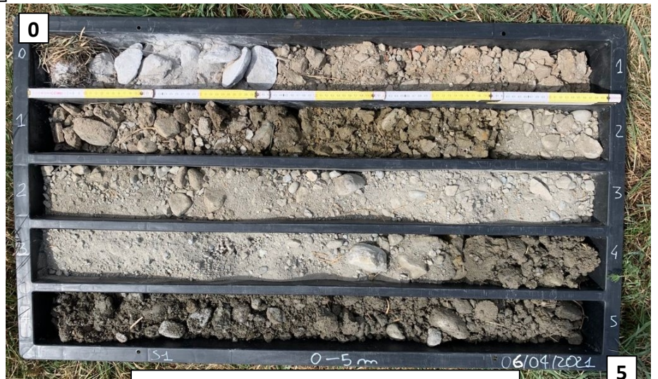
RIGAMONTI SALUMIFICIO S.p.A. Montagna in V.na (SO) SONDAGGIO S1 Cassetta da m 0.00 a m 5.00
