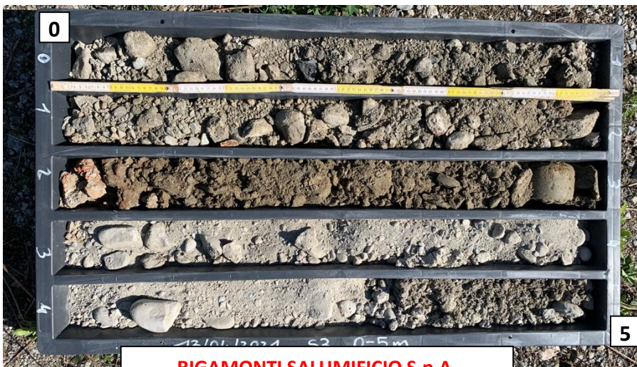
RIGAMONTI SALUMIFICIO S.p.A. Montagna in V.na (SO) SONDAGGIO S3 Cassetta da m 0.00 a m 5.00
